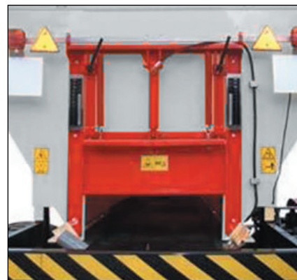
СПЕЦИАЛЬНОЕ ШИРОКОЕ ВЫГРУЖНОЕ ОКНО ДЛЯ КОМПОСТА
