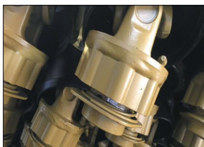
КАРДАНЫЙ ВАЛ С ОГРАНИЧИТЕЛЕМ КРУТЯЩЕГО МОМЕНТА
